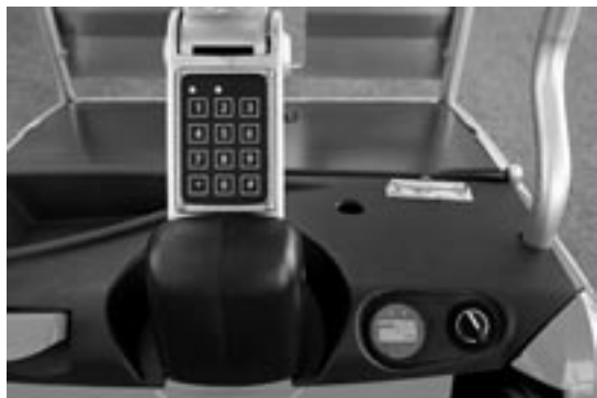
2 Programas de traslación, Eco y Boost, para potencia adaptada y eficiencia de energía en cada situación.
